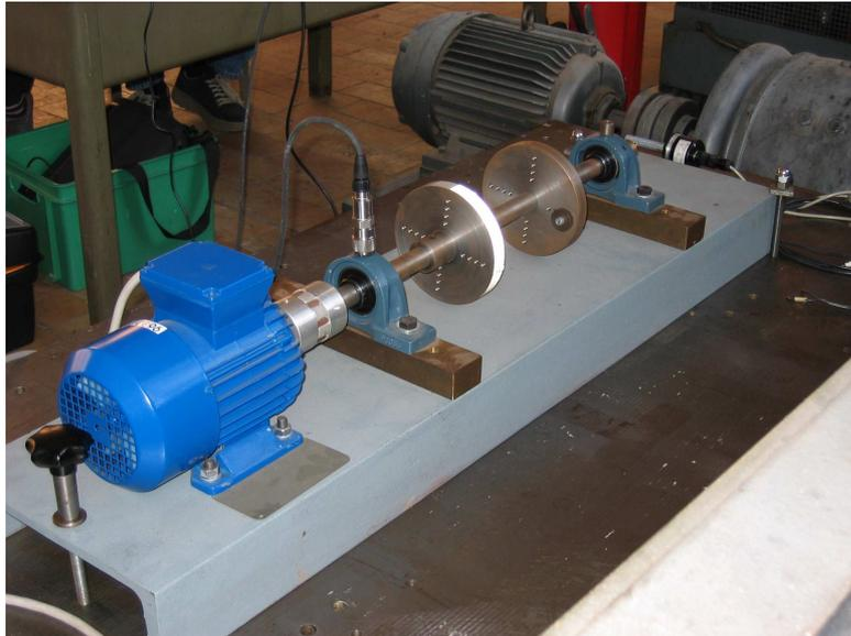
FIG. 3.1 – Banc d'essais simulateur de défauts mécaniques.
