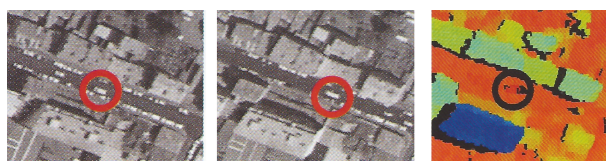
Figure 7.13 – Corrélation, problème lié aux éléments mobiles (voitures par exemple).
