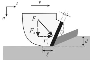
La réalisation d'essais de coupe avec chacun des supports pris seul permet de déterminer la réponse individuelle de chaque pastille dans la configuration de découpage.
