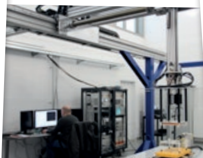
Nouveau banc de test Eurobalise (bâtiment Multitel)
