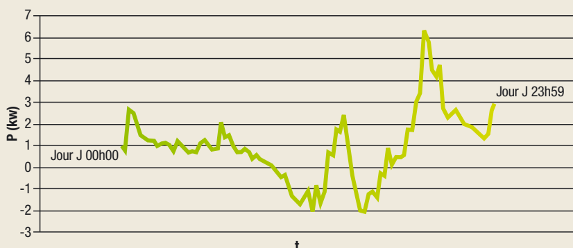
Illustration de l'influence sur la direction du flux énergétique transitant sur le réseau de distribution de la production d'énergie issue de panneaux photovoltaïques installés chez un client résidentiel
