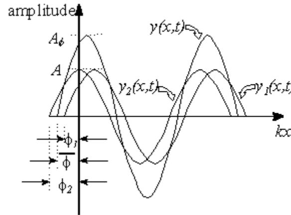
Si  $\Delta\Phi = 0^\circ$ , il y a une interférence **constructive**; alors  $\cos(\Delta\Phi / 2) = 1$  et  $A_{inter} = 2$ .
