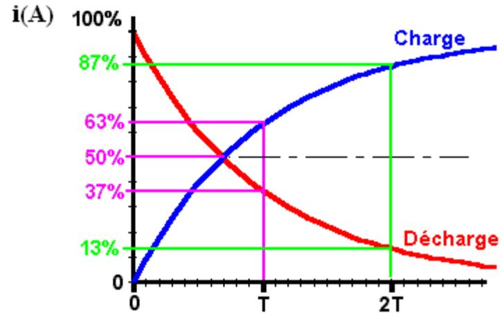
Courbes en courant de charge et décharge d'un circuit RL
