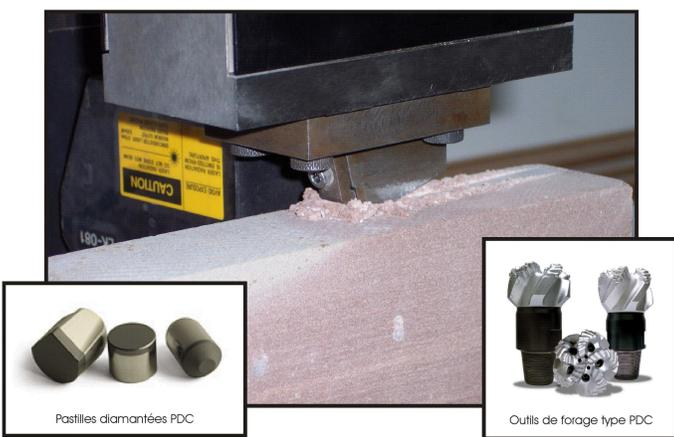
Figure 1 : La compréhension des mécanismes de destruction des roches par les outils PDC nécessite l'étude locale des pastilles, et la réalisation de test à pastille unique.
