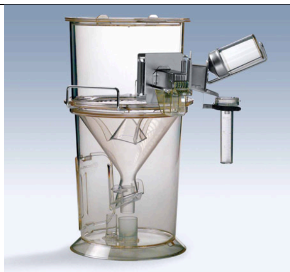
Fig. 23 : Représentation d'une cage à métabolisme (39). La partie inférieure du dispositif permet de récolter et de séparer les urines et les fèces des rongeurs séjournant dans la partie supérieure.
