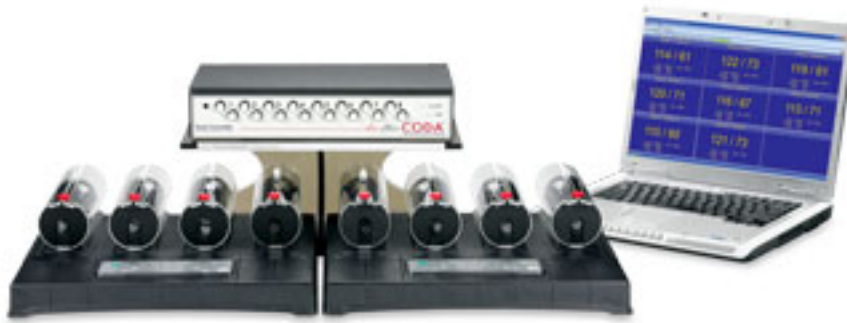
Fig. 24 : Photo du dispositif produit par Kent Scientific Corporation™ permettant la mesure non-invasive de tension artérielle chez les rongeurs (42). Le rongeur est placé dans un cylindre de contention visible en plusieurs exemplaires sur cette photo.
