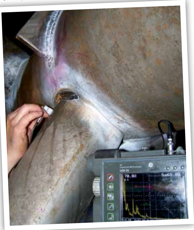
Contrôle par ultrasons de pièces d'acier
