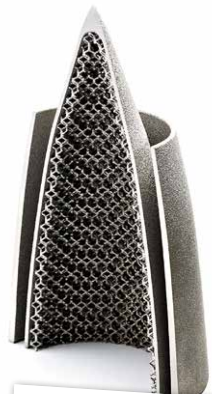
Pièce obtenue par EBM, impossible à fabriquer avec un procédé traditionnel
