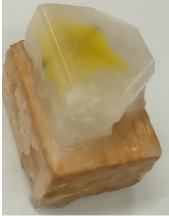
Figure 35 Bloc de paraffine fixé sur le support en bois.
