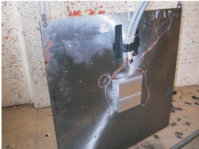
FIG. B.8 – Dispositif d'essai en configuration double plaque avec équipement
