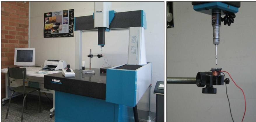
(a) Machine à Mesurer Tridimensionnelle (b) Disposition du relais
