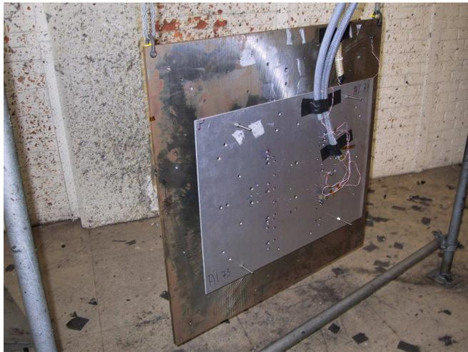
FIG. B.5 – Moyen d'essais à deux plaques verticales
