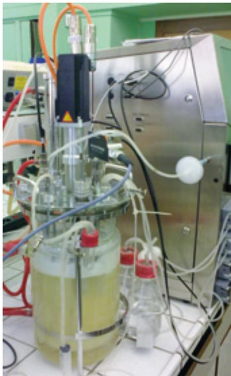
Figure 1 : Bioréacteur pilote de 5 litres
