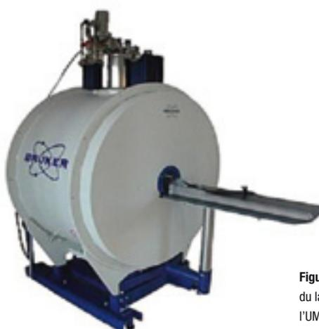
Figure 5 : Aimant du système IRM petit animal 7T du laboratoire de RMN et d'Imagerie Moléculaire de l'UMons et images des coupes du crâne d'un rat.
