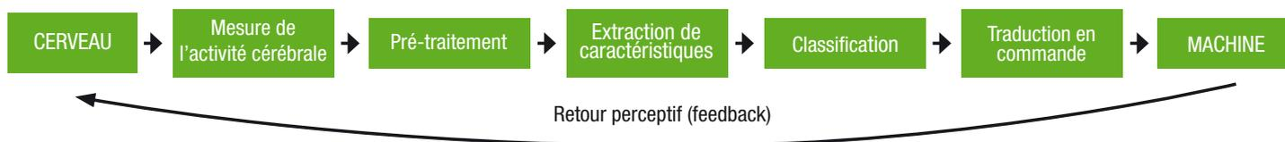
Figure 1: Principe de fonctionnement d'une interface cerveau-machine
