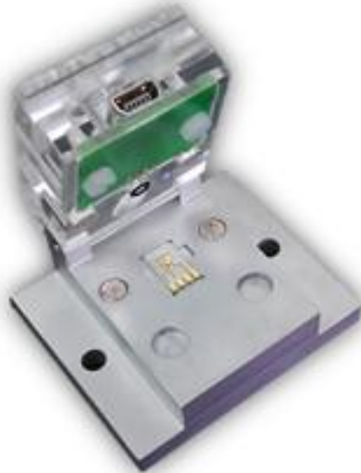
Figure 103 : Cellule électrochimique avec électrodes lithographiées adaptée aux systèmes microfluidiques commercialisé par Micrux (Oviedo, Espagne)
