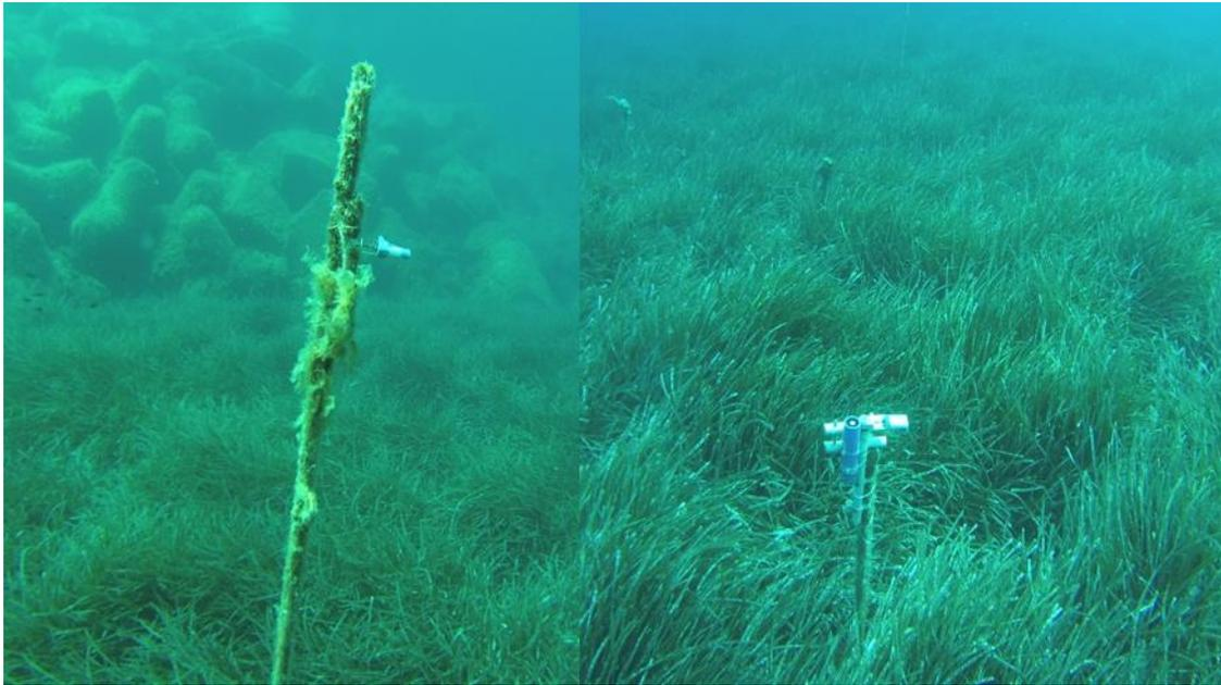
Figure 13 : Photographie des sondes HOBO et Odyssey (photo : Guyliann Engels). À gauche, la sonde HOBO mesurant l'intensité lumineuse (lx) et la température (°C). À droite, la sonde Odyssey mesurant le PAR ( $\mu\text{mol de photons.m}^{-2}.\text{s}^{-1}$ ).
