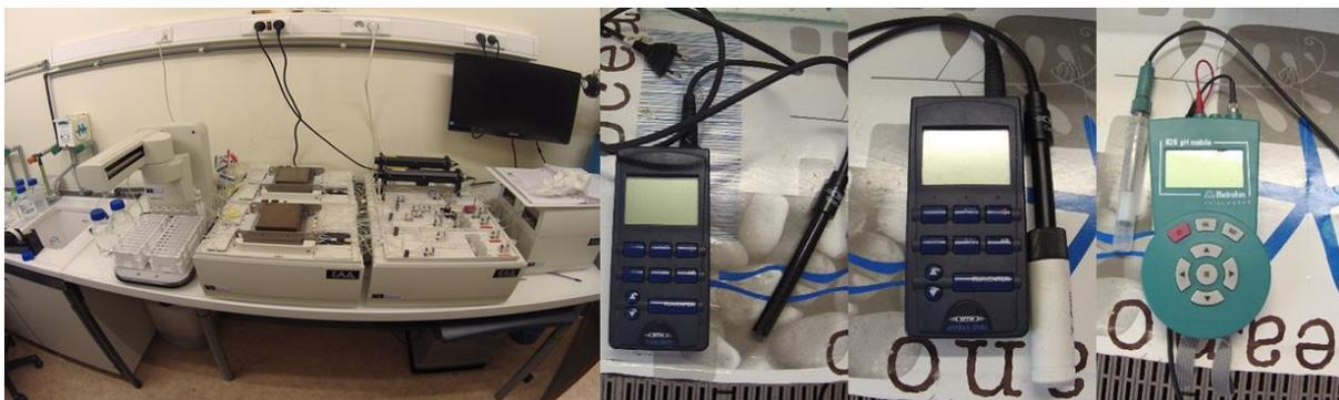
Figure 19 : Photographie de l'auto-analyseur (photo : Guyliann Engels) et des instruments de mesures des paramètres physicochimiques (photo : Guyliann Engels). À gauche, l'autoanalyseur. À droite, le salinomètre, l'oxymètre et le pHmètre.
