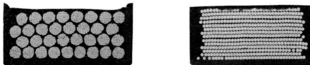
Figure 3.1: Illustration des incertitudes sur positions et diamètres des conducteurs à partir d’une section plane de la fenêtre de bobinage
