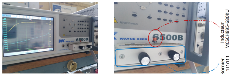
Figure 6.2: Mesure à analyseur d'impédance Wayne Kerr 6500B (gauche) et montage composant sur le bornier (droite)
