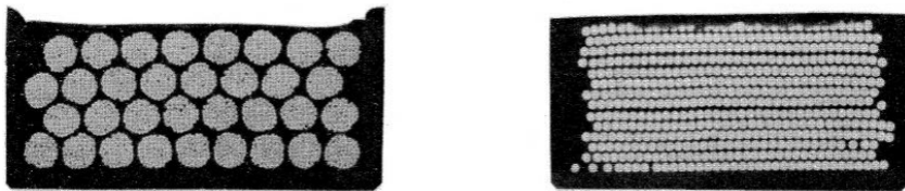
Figure 4.1: Vue en coupe de deux enroulements bobinés à la main pour une fenêtre de bobinage de 9,18 \times 4,0 = 36,72 \text{ mm}^2 [68].
