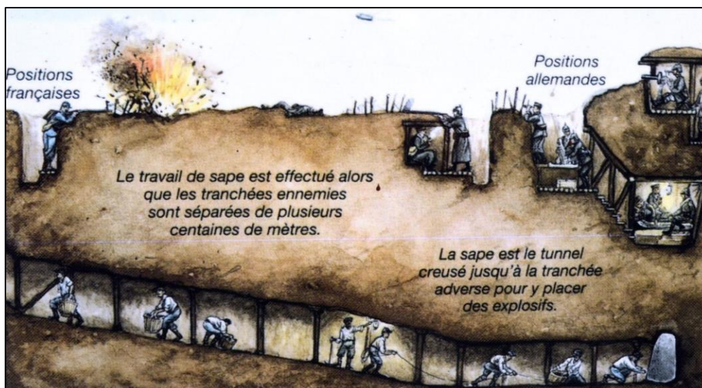
Figure 2 : Configuration typique d'un sape de la Première Guerre Mondiale (source : Sagnier et Rochut, 2003).
