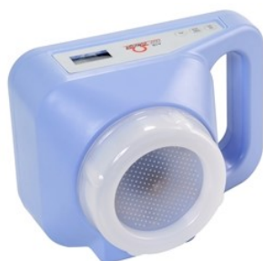
FIGURE 10.2 – Biocollecteur d'air - Air Ideal
