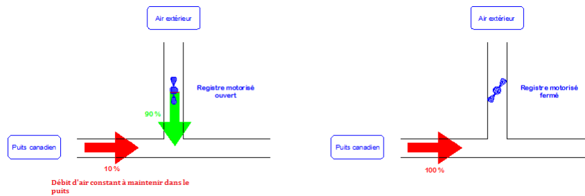
FIGURE 1.3 – Fonctionnement du by-pass
