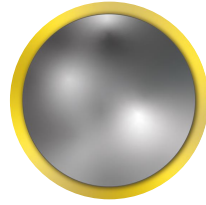
Magnetite core : 95 nm Gold shell : 10 nm
