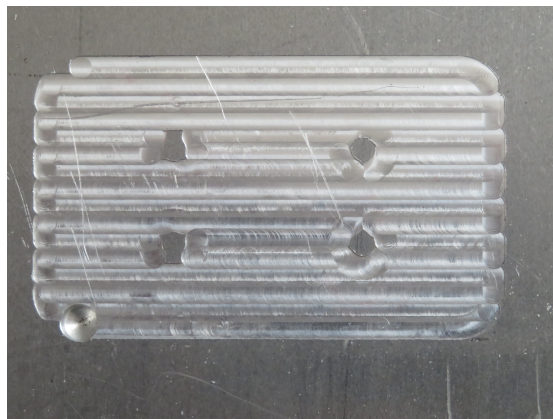
FIGURE D.7 – Cavité RI4M - Trajectoire ZZ
