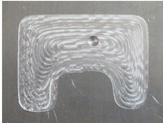
FIGURE D.3 – Cavité HUM - Trajectoire HQ
