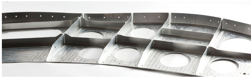
FIGURE 1.2 – Exemple de cavités usinées - domaine aéronautique [91]
