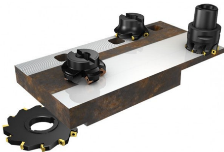
(a) Opération de surfacage [110]
