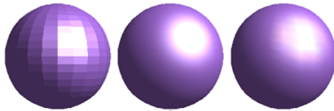
Figure 11.45 – Comparaison des trois méthodes de shading (tiré de http://udn.epicgames.com/ ).
