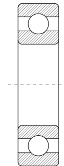
FIGURE 3.69 – Représentation simplifiée d'un roulement à billes.
