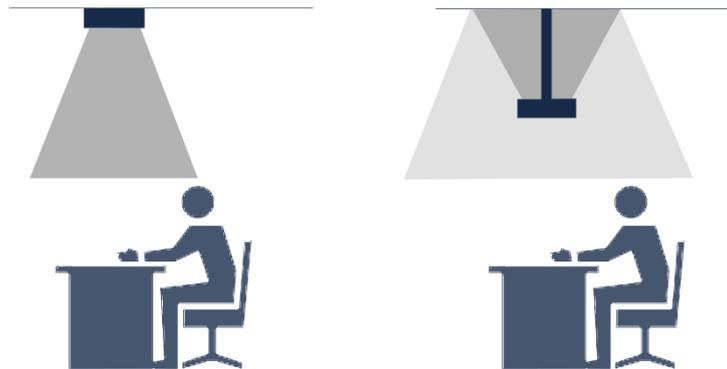
FIGURE 121 : Comparaison de l'éclairage direct et indirect, schéma personnel.
