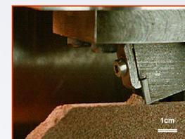
Fig. 4 : Vue détaillée sur une plaquette en PDC utilisée pour réaliser le test de grattage.
