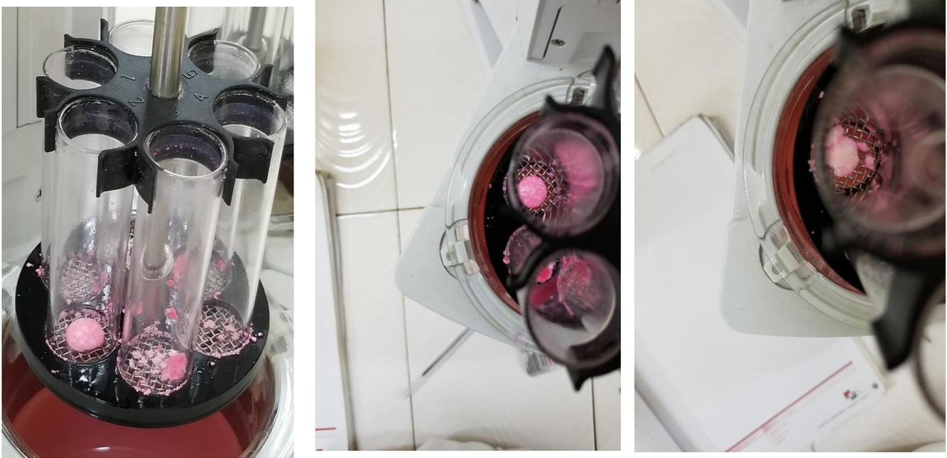
**Figure 31. Illustration de l'échantillon ayant échoué à l'essai de désagrégation**
