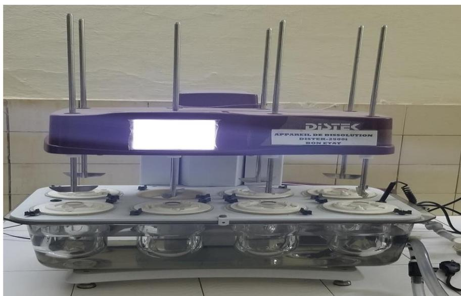
**Figure 7. Appareil de dissolution du Laboratoire de Galénique et Analyse des médicaments de la Faculté des Sciences Pharmaceutiques/Université de Lubumbashi. (Nom de la marque : Distek-25001 ; Fabricant : Distek, Inc., Ville : North Brunswick, pays : Etats-Unis (Photo Mwamba).**
