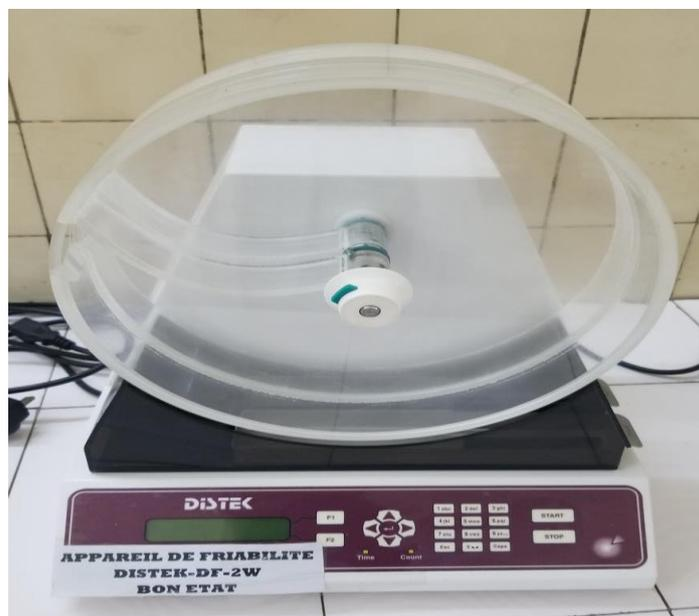
**Figure 5. Appareil de friabilité du Laboratoire de Galénique et Analyse des médicaments de la Faculté des Sciences Pharmaceutiques/Université de Lubumbashi. (Nom de la marque : Distek-DF-2F ; Fabricant : Distek, Inc., Ville : North Brunswick, pays : Etats-Unis (Photo Mwamba).**
